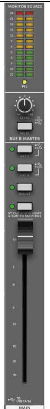
Considerando che l'Insert Send è a guadagno unitario, fornirà anche un'utile uscita *splittata Main Bus* di pre-processamento e *pre-fader*. L'Insert Return commutato, invece, fornisce anche un ingresso diretto *pre-fader* nel circuito del compressore principale del BiG SiX, in modo che lo stesso circuito possa essere utilizzato al di fuori del normale flusso di segnale della console.
