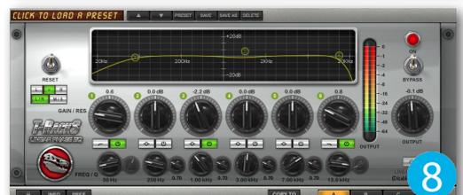
**Compressore Classico** (Figura 10): è in grado di emulare il suono analogico dei dispositivi analogici e viene spesso impiegato nella fase di mastering. Oltre alla sua grande trasparenza che rispetta totalmente le dinamiche musicali, il **Compressore Classico** vi farà ottenere un suono "pieno" e particolarmente "caldo". Provate a caricare il preset **Mastering Tube 1** (o 2) e sentirete subito cosa è in grado di fare!
